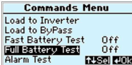
Das Verhalten des „Full battery test“ gleicht dem des „Fast battery test“, wobei der Test
