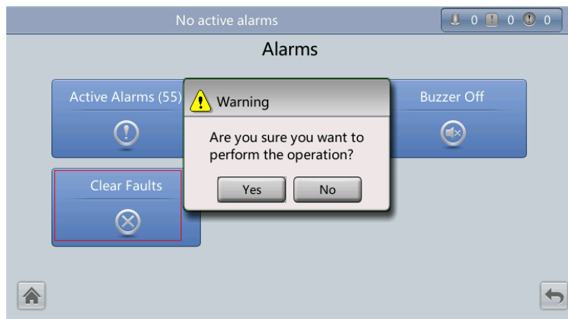
Figure 4-25 Bildschirm "Clear Faults" (Fehler beheben)
