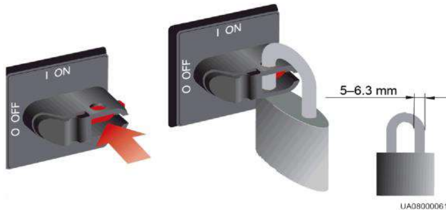
Abbildung 3-16 Einbau eines Schlosses für den Wartungs-Bypass-Schalter
