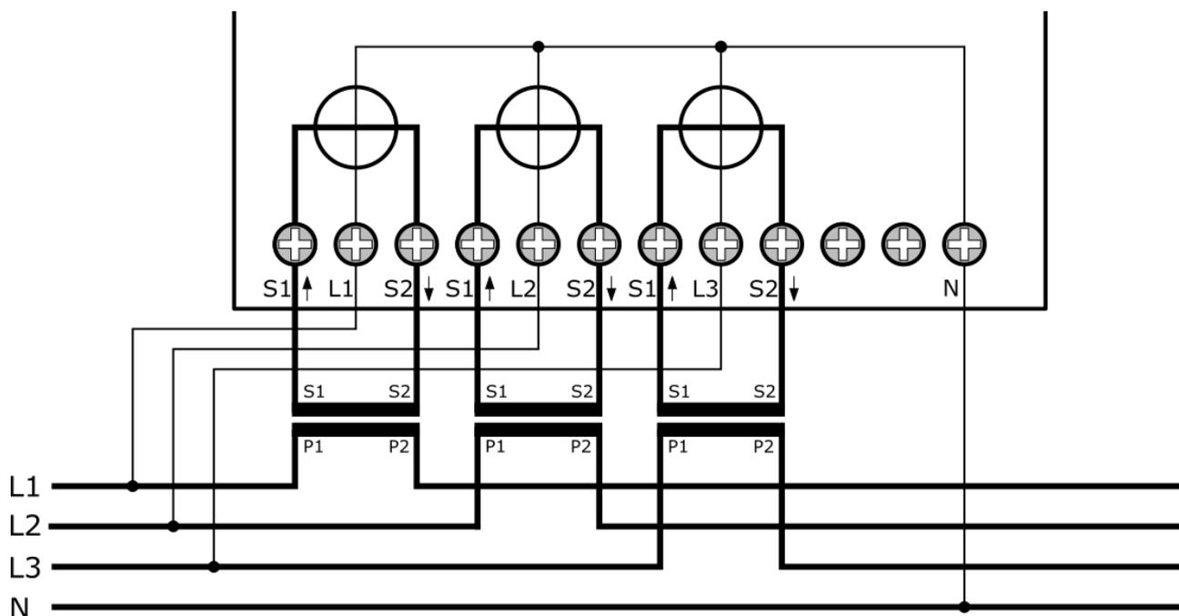
Beim Wandleranschlusszähler wird die Spannung extern abgegriffen. Schliessen Sie jeweils bei den "Lx" die Phase an. Der Neutralleiter wird bei der Klemmen "N" angeschlossen.
