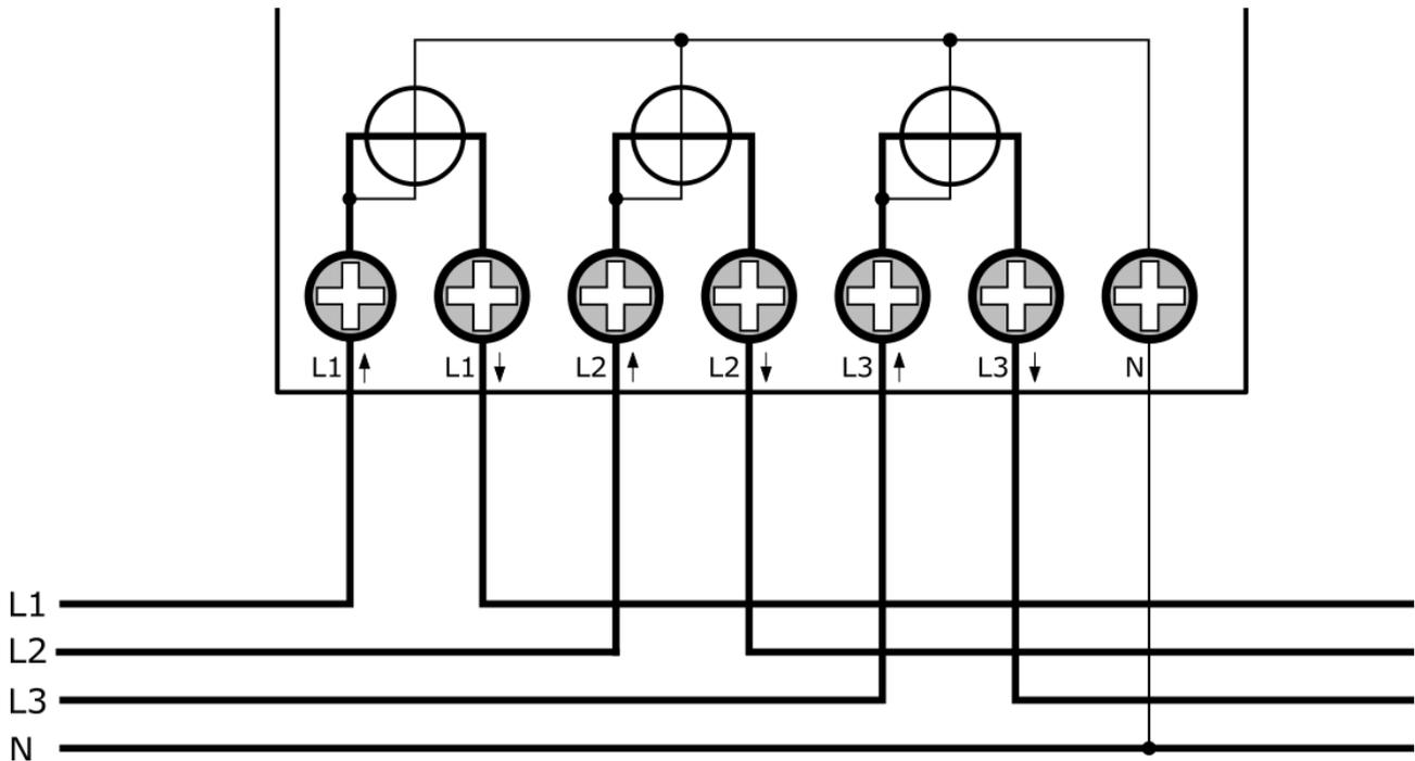
Beim Direktanschlusszähler wird die Spannung intern abgegriffen. Der Neutralleiter wird bei der Klemmen "N" angeschlossen.
