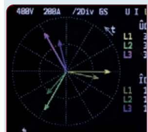
Zeigerdiagramm von Spannung und Strom zur Analyse des Phasenwinkels
